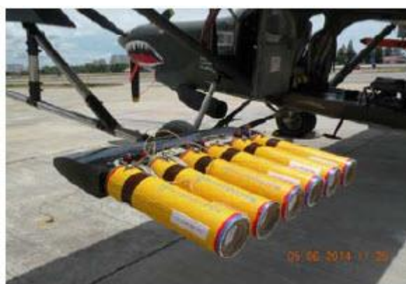
ภาพที่ 2 ติดตั้งเครื่องมือ/อุปกรณ์ระบบจุดพลู
