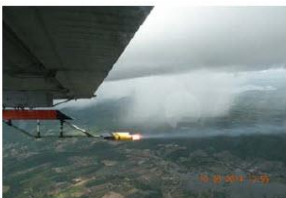
ภาพที่ 1 เครื่องบิน AU-23A บินจุดพลูทำฝน
